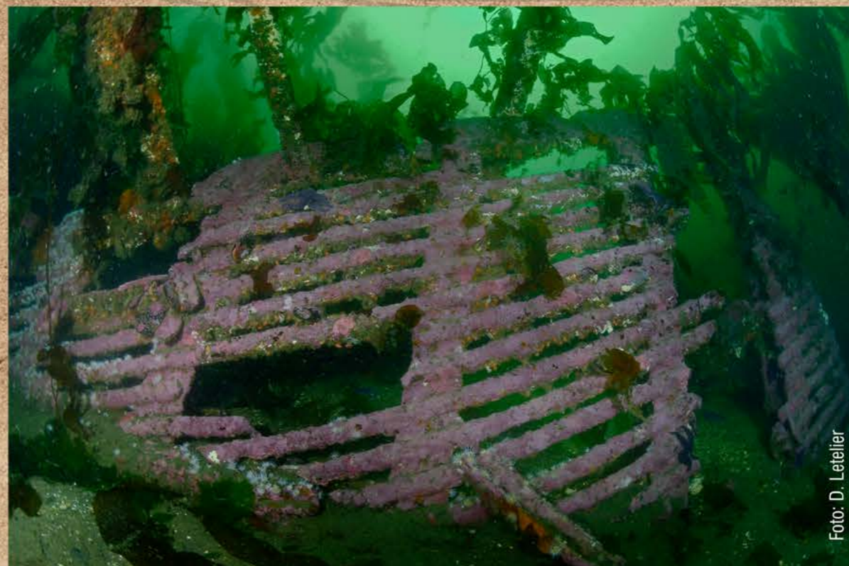
Pasarela del costado de la rueda de babor, colapsada.
